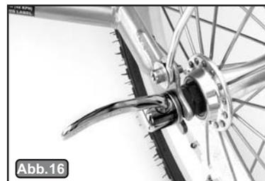
Schnellspannhebel im 90-Grad-Winkel zur Stirnfläche des Ausfallendes.
